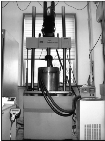
图2 MTS-810 低温三轴试验系统
