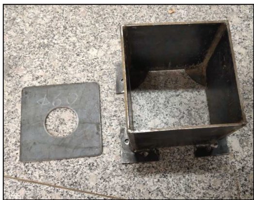
图2 自制试样持土容器
