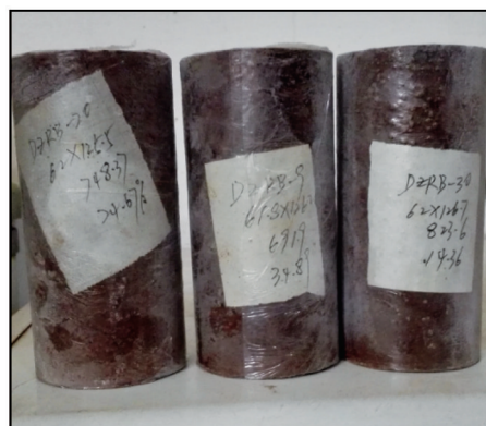
图 3 蠕变试样照片
