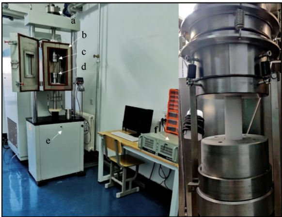
图1 低温单轴压缩试验机和冰样
