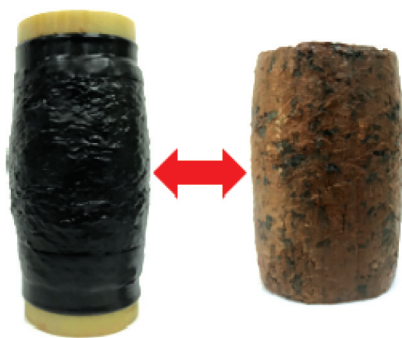
图6 塑性破坏的冻结掺和土料试样
