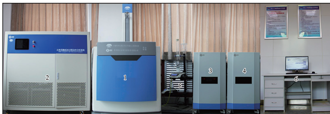
图1 土体冻融成冰过程动态分析系统(1. 磁体单元;2. 土样控温系统;3. 射频系统;4. 成像系统;5. 补水系统;6. 显示系统)
