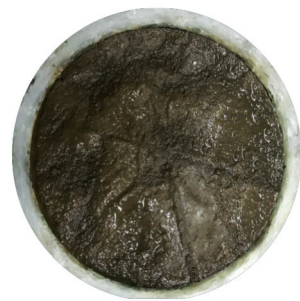
图11 水分重新返回粉质黏土土柱顶部土层
